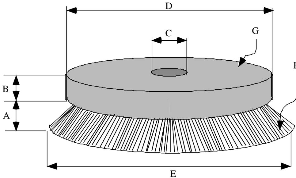
A- Altura de la cerda: \_\_\_\_\_ B- Espesor de la base: \_\_\_\_\_ C- Centro: \_\_\_\_\_
